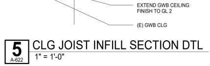
BLOWN-IN INSULATION - (E) 2ND FLOOR SHEATHING AND TECTUM CLG FINISH - 2X BLOCKING BETWEEN JOISTS
