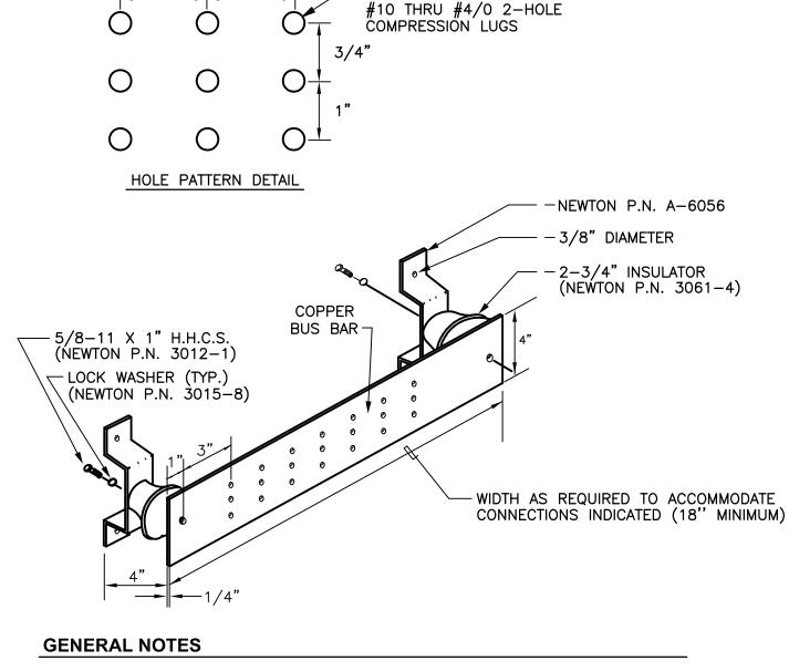
DRILLED HOLES SUITABLE FOR
