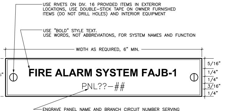
ENCLOSURE, OMIT ENGRAVING IF ENCLOSURE IS NOT POWERED
